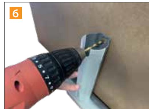
6 Praticare un foro  $\varnothing$  6 in corrispondenza dell'asola superiore della postazione ed inserire un tassello in nylon  $\varnothing$  6 mm ed una vite.
