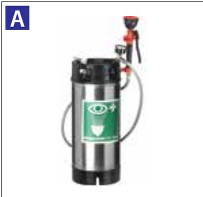
La doccia di soccorso portatile è ideale per il primo lavaggio di occhi, viso e mani in caso di contatto accidentale con prodotti chimici o aggressivi. Strutturata per essere facilmente trasportabile, consente l'accesso immediato ad una fonte di acqua corrente. La doccia portatile EASY SHOWER è dotata di un fusto inox da 18 l con doccietta estraibile, manometro e valvola di sicurezza per il sovraccarico di pressione.
